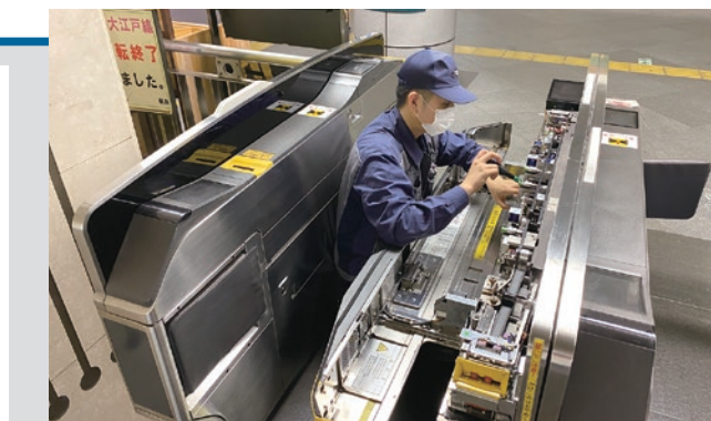
▲ 自動改札機の保守点検
