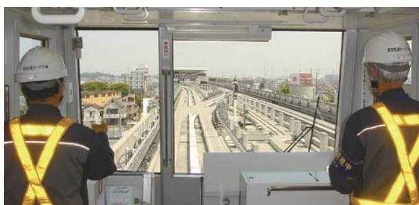
▲ 車両添乗による走行路点検
